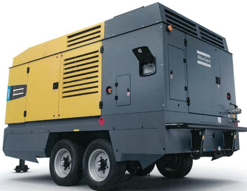
Los compresores Atlas Copco H23 Sd son compresores de aire de tipo inyección de aceite de dos etapas asimétrica de tornillo rotativo accionados por un motor Scania de seis cilindros turbo motor intercooler refrigerado por líquido.
