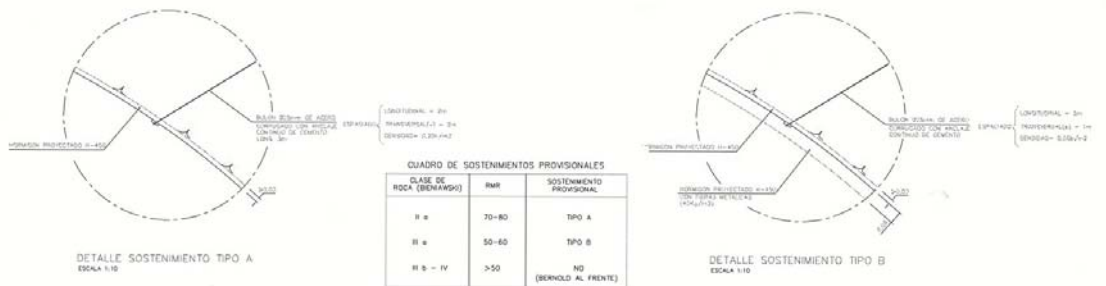
Figura 3. Sostenimientos empleados en el túnel 2 de Gandía.
